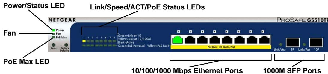
**Figure 2. GS510TP Front Panel**
