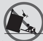
**AVERTISSEMENT :** La bride antibasculement doit être convenablement installée afin de réduire le risque de basculement de l'appareil lors d'une utilisation anormale ou d'un chargement excessif de la porte du four.
