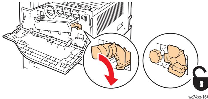
4. Tournez le bouton orange dans le sens inverse des aiguilles d'une montre afin de le desserrer.
