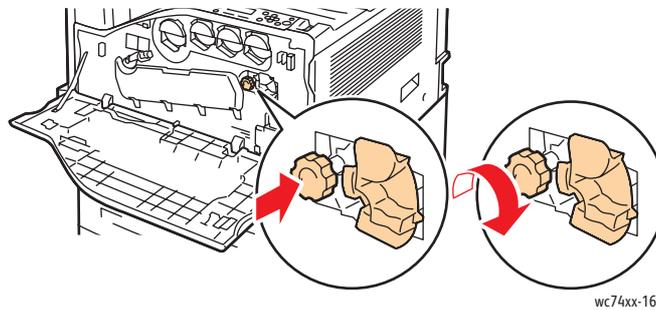
10. Tournez le levier orange vers la gauche afin de verrouiller le nettoyeur de courroie.
