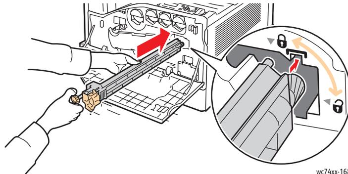
9. Appuyez sur le bouton orange, puis tournez-le dans le sens des aiguilles d'une montre jusqu'à ce qu'il soit correctement serré.
