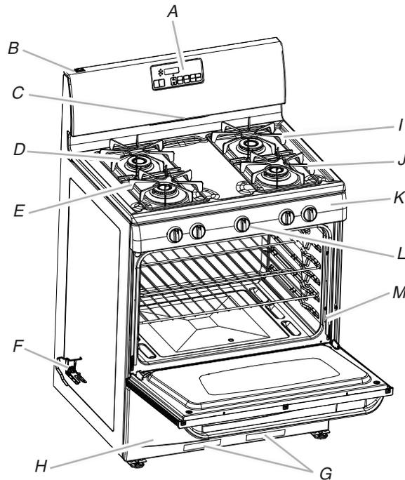
A. Module de commande électronique du four (sur certains modèles)
