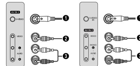
➤ Debe hacer coincidir los colores de los terminales de entrada y de las tomas de cables. Cuando los conectores (AV IN 2) laterales y traseros estén conectados a equipos externos, los laterales tienen prioridad para recibir la señal.
