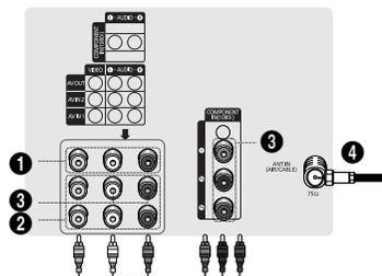
➤ Al conectar un sistema de audio o vídeo al televisor, asegúrese de que todos los elementos estén apagados. Debe hacer coincidir los colores de los terminales de entrada y de las tomas de cables.
