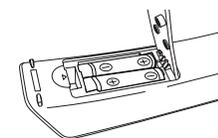
Si el mando a distancia no funciona con normalidad, compruebe que los polos "+" y "-" de las pilas estén correctamente orientados o que las pilas estén secas.
