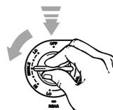
• Appuyer sur le bouton de commande et le tourner vers la gauche (sens antihoraire) jusqu'au réglage désiré dans la zone marquée "SINGLE".
