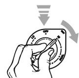
• Appuyer sur le bouton de commande et le tourner vers la droite (sens horaire) jusqu'au réglage désiré dans la zone marquée "DUAL".
