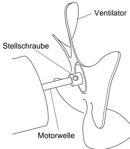
**Abbildung 17 - Ventilator, Motorwelle und Lage der Stellschraube**
