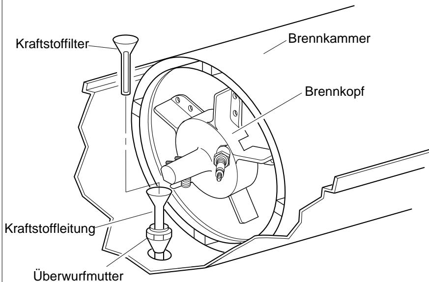
Abbildung 6 - Entfernen des Kraftstofffilters
