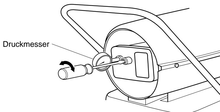
Abbildung 11 - Pumpendruck-Einstellung
