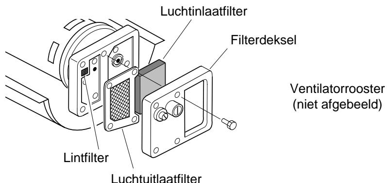
Figuur 9 - Luchtinlaat-, luchtinlaat- en lintfilter
