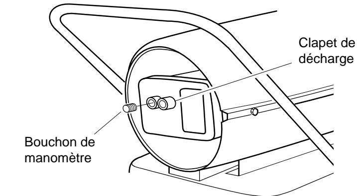
Figure 10 - Dépose du bouchon du trou du manomètre
