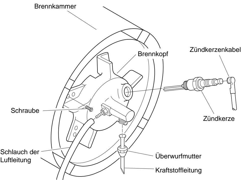
Abbildung 12 - Entfernen des Brennkopfes
