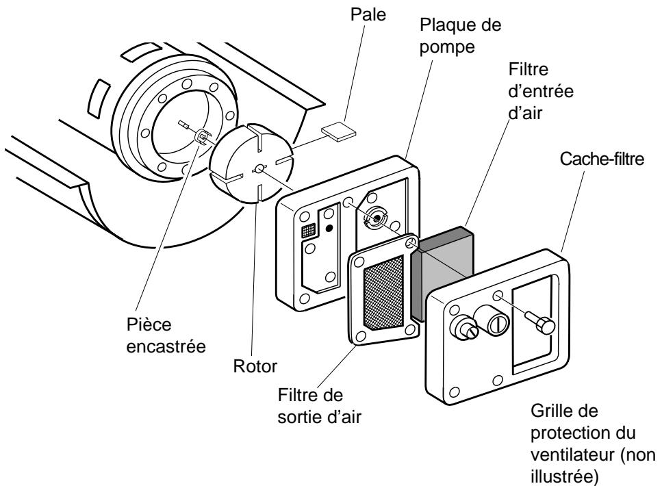
Figure 14 - Emplacement du rotor
