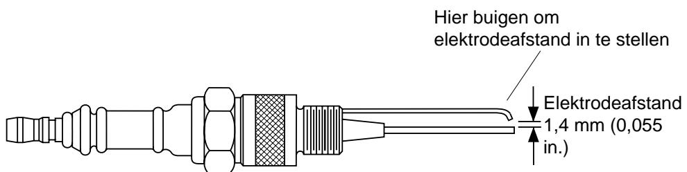
Figuur 8 - Elektrodeafstand
