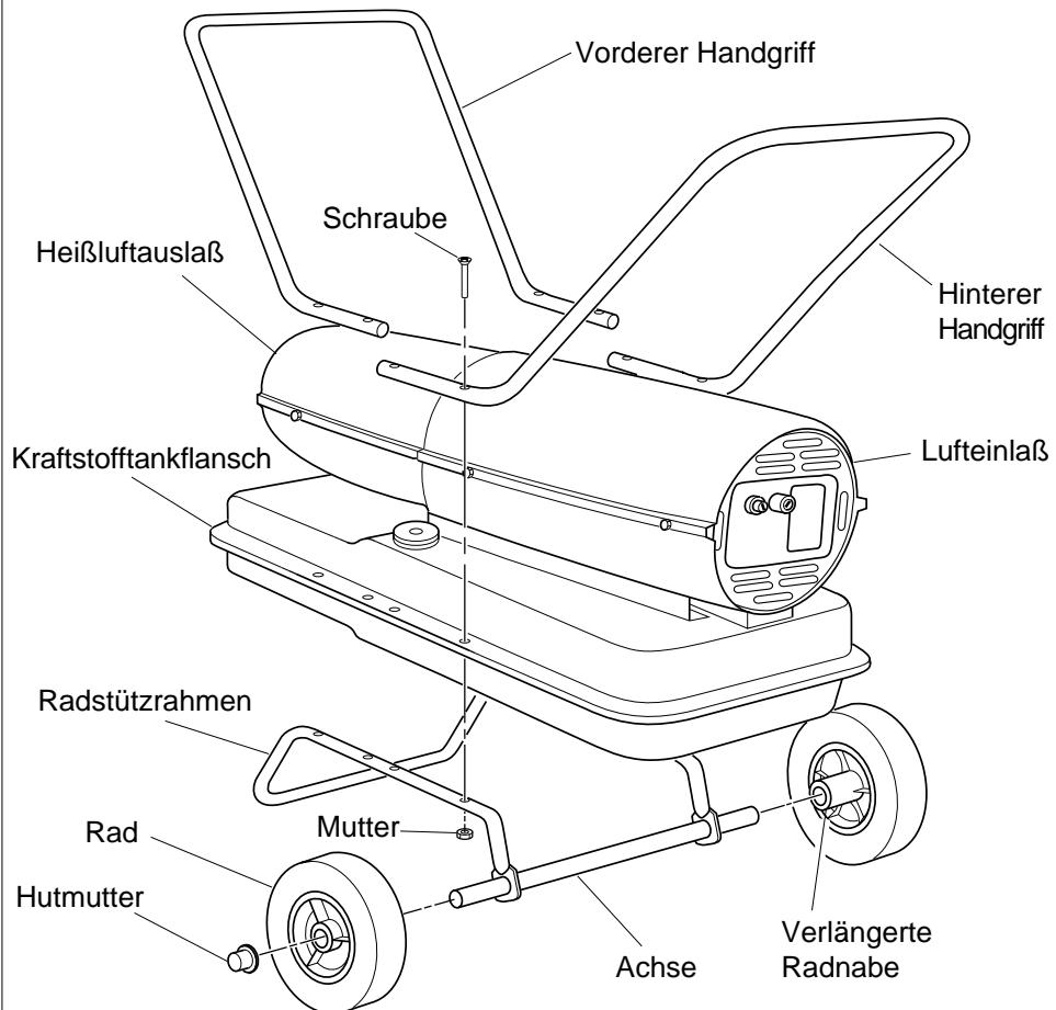
**Abbildung 2 - Zusammenbau von Rädern und Handgriff**
