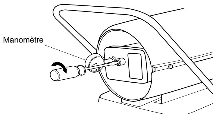
Figure 11 - Réglage de la pression de la pompe
