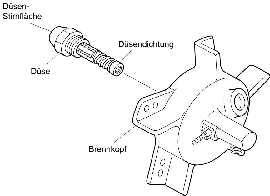
**Abbildung 13 - Entfernen der Düse**
