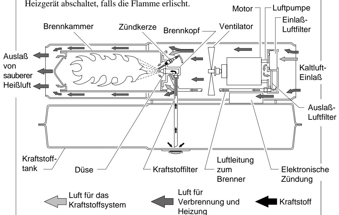
Abbildung 3 - Querschnitt - Funktionsschema
