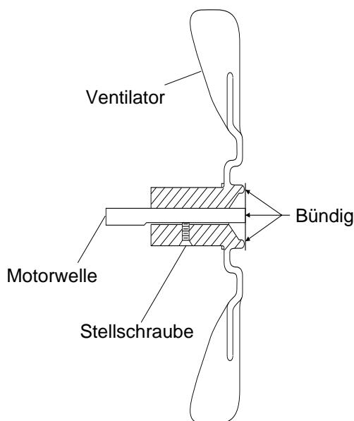
**Abbildung 18 - Querschnitt, Ventilator**
