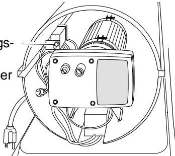
**Abbildung 4 - Sicherheitsvorrichtungs-Rückstellknopf**
