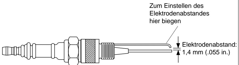
**Abbildung 8 - Zündkerzen-Elektrodenabstand**
