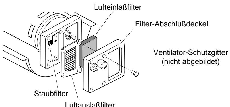
**Figure 9 - Air Output, Air Intake, and Abbildung 9 - Luftauslaß-, Lufteinlaß- und Staubfilter**
