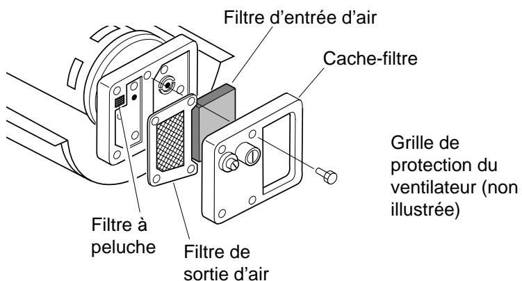
**Figure 9 - Filtres de sortie d'air, d'entrée d'air et à peluche**
