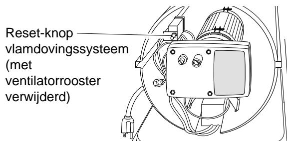
Figuur 4 - Reset-knop vlamdovingssysteem
