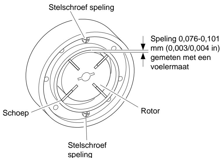
**Figuur 15 - Plaats van stelschroeven speling**
