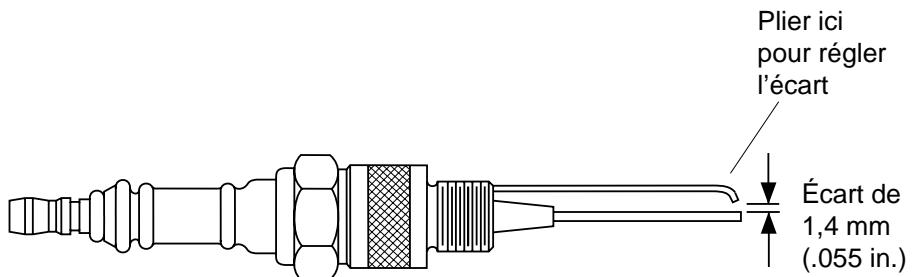
**Figure 8 - Écart des électrodes de la bougie**
