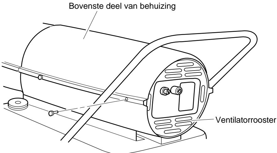
Figuur 5 - Verwijderen van bovenste deel van behuizing
