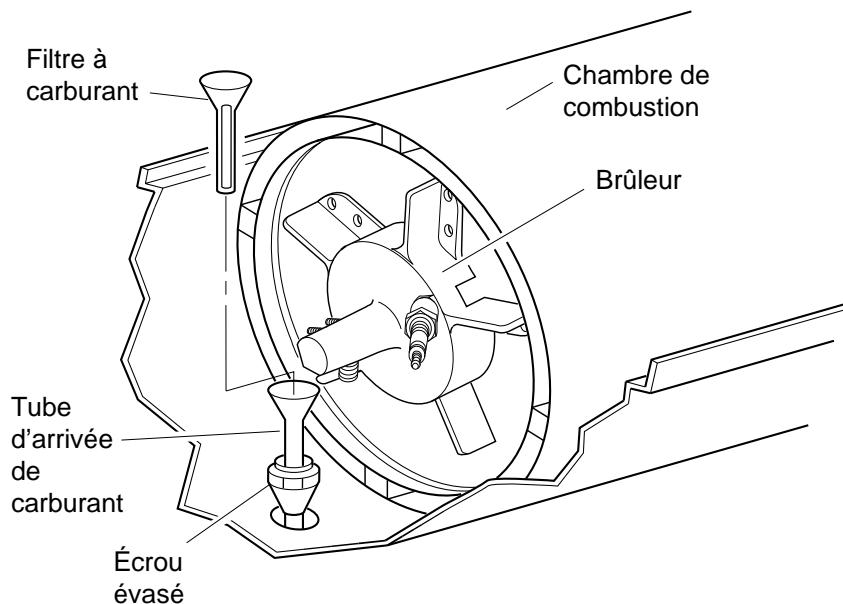
**Figure 6 - Dépose du filtre à carburant**
