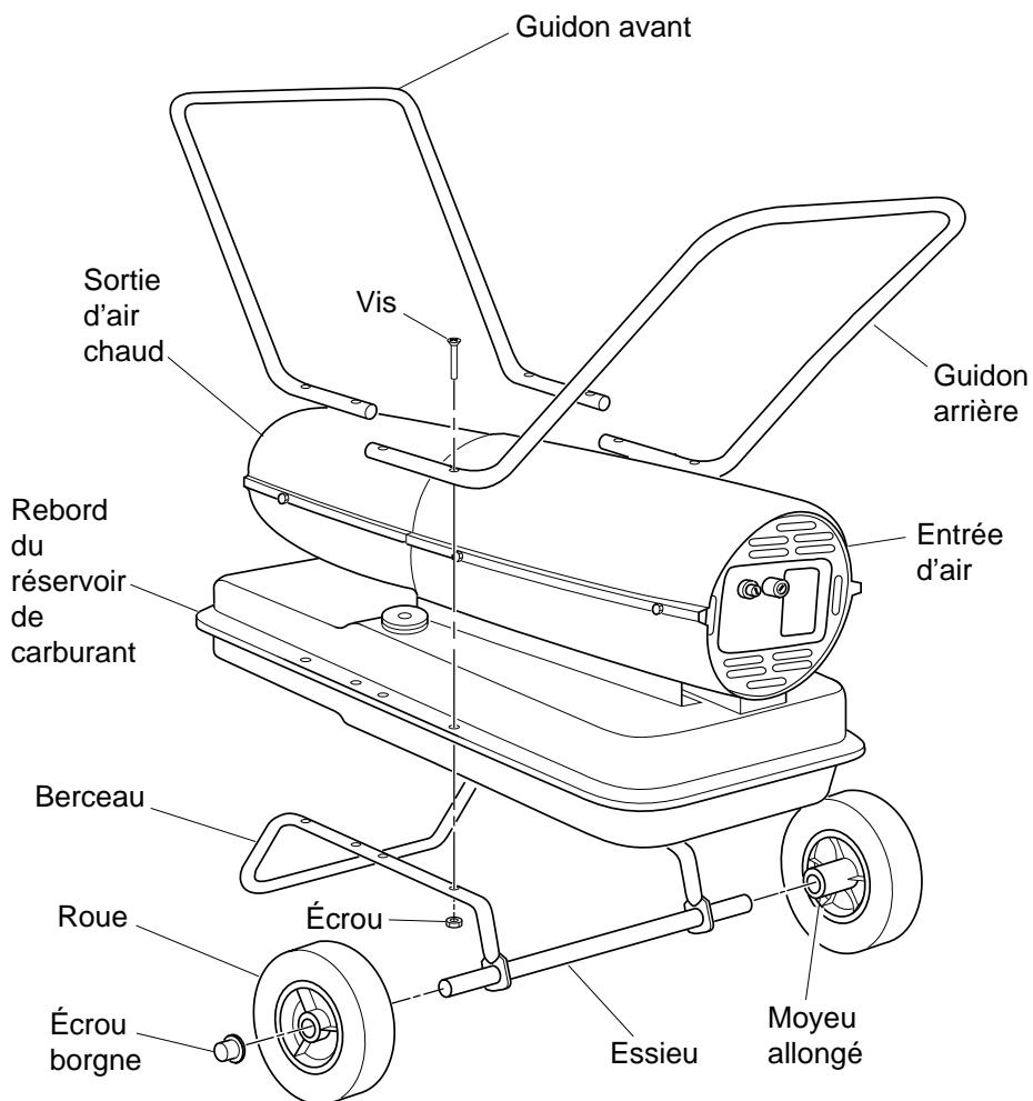
**Figure 2 - Montage des roues et des guidons**
