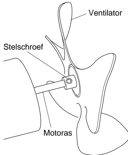
**Figuur 17 - Plaats van ventilator, motoras en stelschroef**
