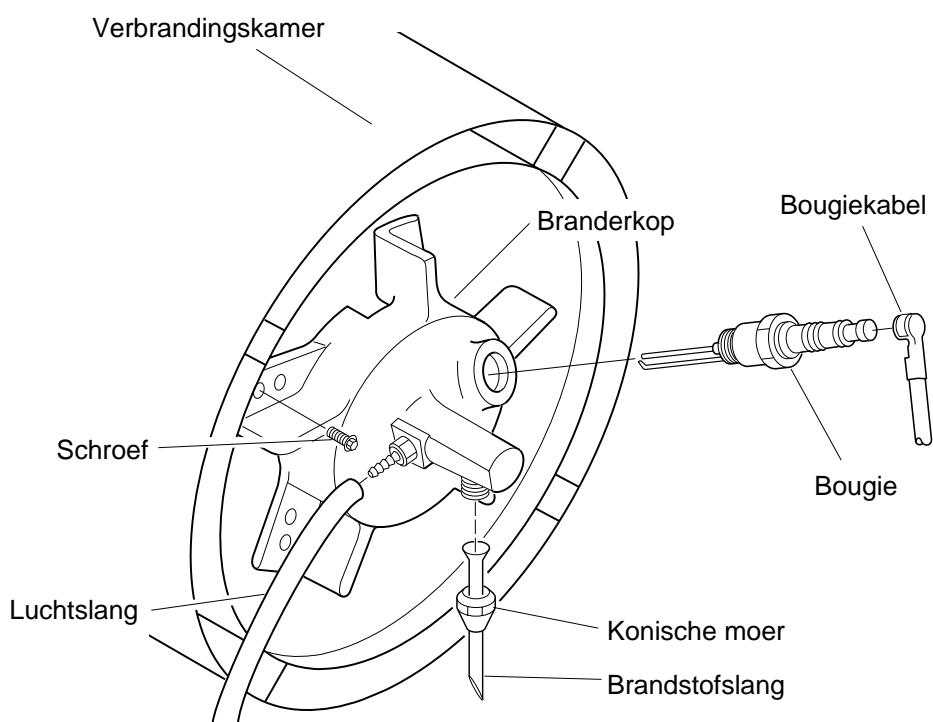
Figuur 12 - Verwijderen van branderkop
