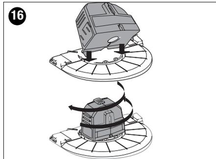
**(2) Posición fija** - Para usar el láser en la posición fija, coloque las patas traseras en los agujeros del transportador. Consulte la **figura 17** para ver los ángulos creados cuando se usa el láser en estos agujeros.
