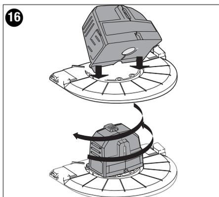
**(3) Rapporteur sur l'arête de l'ouvrage** – pour utiliser le laser sur l'arête de votre ouvrage, faites pivoter les pieds du rapporteur de sorte qu'ils soient verticaux
