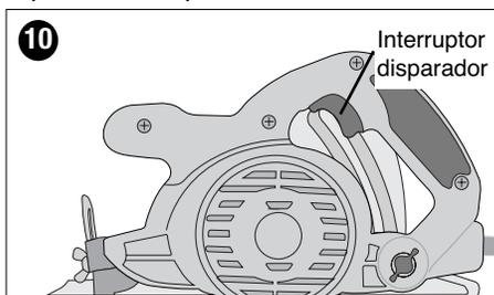
Para apagar la herramienta, suelte el interruptor disparador. No se prevé un dispositivo para mantener la herramienta en marcha constante, y nunca se debe trabar el interruptor por ningún medio.
