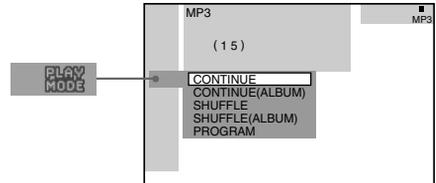
**3** Select **SHUFFLE** or **SHUFFLE (ALBUM)** using **↑/↓** and press **ENTER**.
