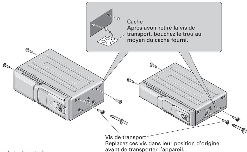
Des vis sont fixées sur le lecteur de façon à le protéger pendant le transport. Après avoir retiré une vis de transport, bouchez le trou au moyen du cache fourni. Veillez à retirer ces vis avant d'installer le lecteur. Conservez les vis dans le sac contenant les accessoires de manière à ne pas les égarer et à être en mesure de les remettre en place en cas de transport.
