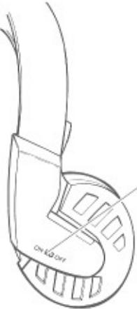
La cuffia a raggi infrarossi HiFi HDI 550 riceve senza cavo l'informazione audio stereo irradiata da un trasmettitore a infrarossi adatto HDI 550.
