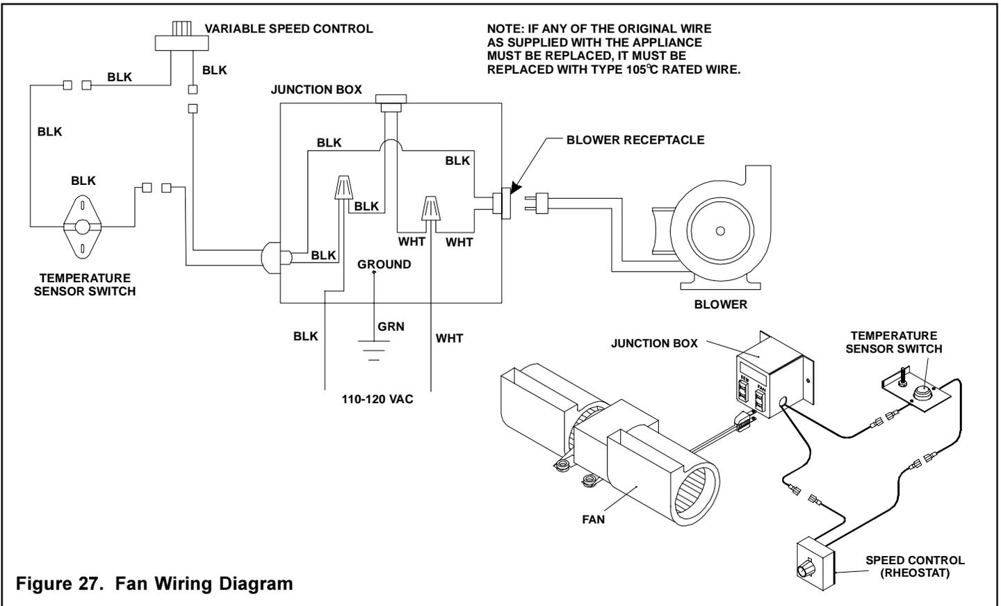
Figure 27. Fan Wiring Diagram
