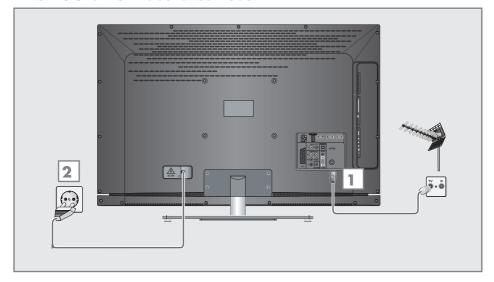
Zum Empfang terrestrischer Digitalsender (DVB-T) das Kabel der Haus- oder Zimmerantenne (passive oder aktive Zimmerantenne mit eigener Stromversorgung) an die Antennenbuchse »ANT IN« des Fernsehgerätes anschließen;
