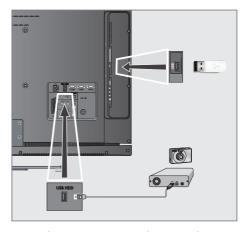
Buchse »USB HDD« des Fernsehgerätes und entsprechende Buchse des Datengerätes (externe Festplatte, Digital-Camera, Kartenlesegerät oder MP3-Player) mit einem USB-Kabel verbinden;
