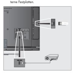
Buchse »USB HDD« des Fernsehgerätes und entsprechende Buchse des Datenträgers (externe Festplatte) mit einem USB-Kabel verbinden;
