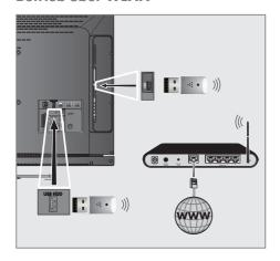
Den Grundig WiFi USB Dongle an die Buchse »USB« oder »USB HDD« des Fernsehgerätes anschließen.
