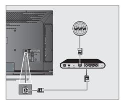
Ausgangsbuchse des Routers mit handelsüblichen LAN-Kabel an die Buchse »LAN« des Fernsehgerätes anschließen.
