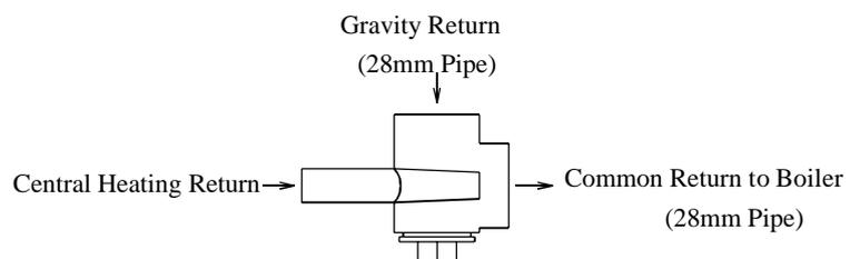
Fig. 7. Injector Tee.
