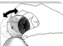
*Regolazione della luminosità del display (monitor)*
