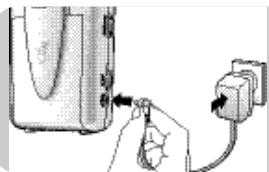
**6** Συνδέστε το καλώδιο του τροφοδοτικού στην υποδοχή τροφοδοσίας (DC 8,0 V - Θ-⊕-⊖- B-12).
