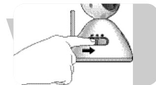
2 Den ON/OFF Schalter der Monitoreinheit (B-8) auf die Position ON stellen.
