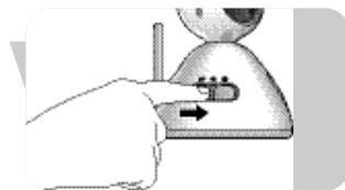
2 Sur l'unité de surveillance, placez l'interrupteur OFF/ON (B-8) en position ON.
