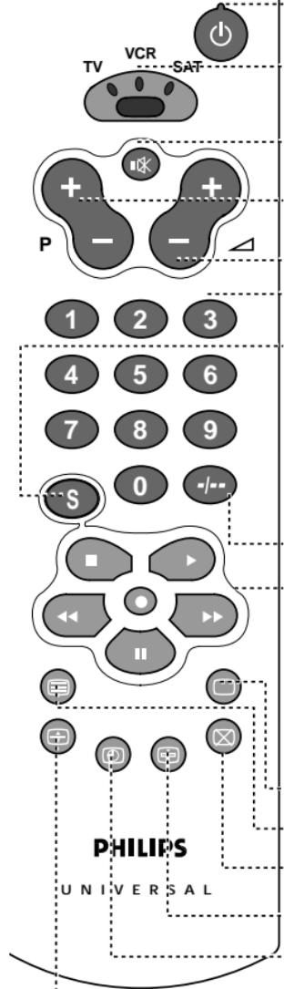
**Met de Bronkeuzetoets** kiest u het apparaat dat u wilt bedienen: TV, VCR, SAT
