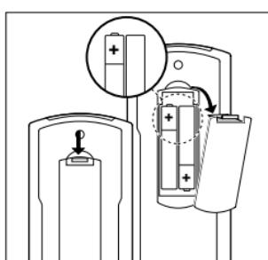
Você irá precisar de duas pilhas de 1,5V; utilize apenas pilhas do tipo R03, UM4 ou AAA. Coloque-as no compartimento conforme ilustrado:
