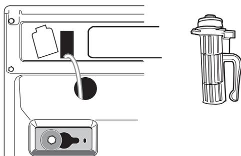
1. Au moyen d'une clé de 13 mm, desserrer les 4 boulons de transport situés à l'arrière de la laveuse.
