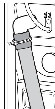
4. Le système de vidange de la laveuse peut être installé à l'aide d'un conduit d'évacuation au plancher, un tuyau rigide de rejet à l'égout mural, un tuyau de rejet à l'égout rigide au plancher ou un évier de buanderie.
