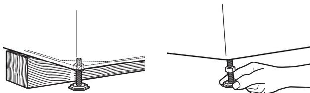
Si la laveuse est placée contre un mur, on doit l'écarter légèrement du mur avant de l'incliner vers l'arrière. Si la laveuse n'est pas d'aplomb, soulever d'abord l'avant à l'aide d'une cale de bois et régler la hauteur des pieds avant en déplaçant la pièce en plastique hexagonale si nécessaire. Répéter pour le réglage des pieds arrière.
