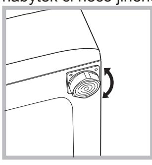
2. V případě, že podlaha není dokonale vodorovná, mohou být případné rozdíly vykompenzovaly šroubováním předních nožek (viz obrázek); Úhel sklonu, naměřený na pracovní ploše, nesmí přesáhnout 2°.
