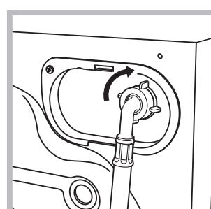
2. Pripojte prítokovú hadicu k práčke, jej zaskrutkováním k príslušnej prípojke na vodu, umiestnejnej vpravo hore (vid' obrázok).
