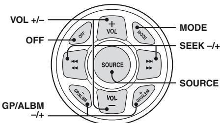
Los siguientes controles del mando a distancia subacuático requieren una operación diferente a los de la unidad.
