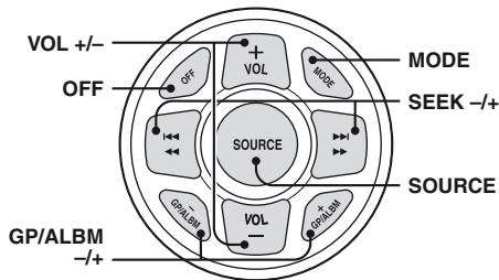
Les commandes suivantes de la télécommande marine ont une fonction différente de celles de l'appareil.
