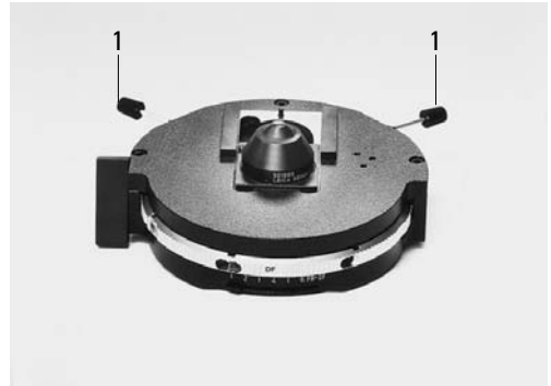
Fig. 29 Méthode de centrage du contraste de phase
