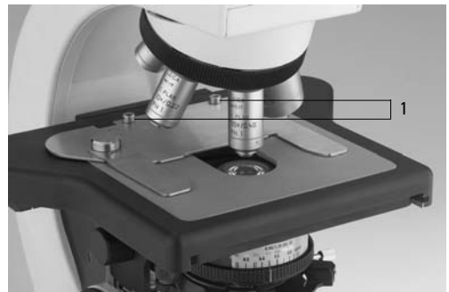
Abb. 3 Objektisch mit Präparatehalter
