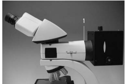
Abb. 17 Ansetzen des Lampenhaus 106z
