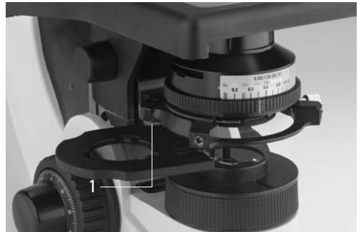
Fig. 19 Montage du porte-polariseur*
