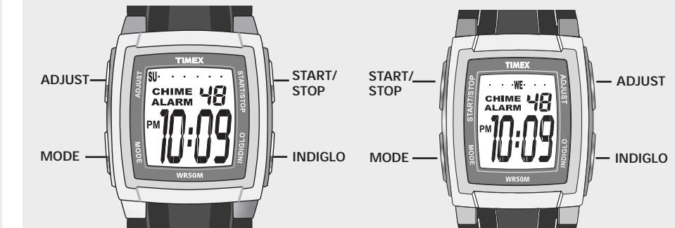
Pulse **MODE** para ajustar la hora, fecha y alarma o ingrese Chrono (cronómetro). Pulse **INDIGLO** para iluminar la cara del reloj. En cualquier modo, pulse **MODE** para ver la hora. Pulse cualquier botón para silenciar la señal acústica de la alarma.
