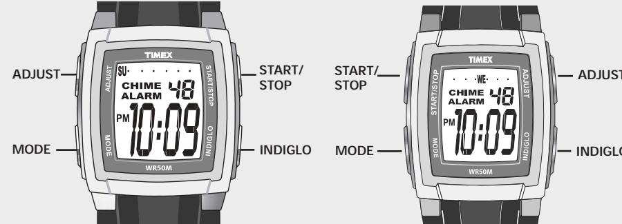
Appuyer sur **MODE** pour ajuster l'heure, la date et l'alarme ou entrer en mode Chrono. Appuyer sur **INDIGLO** pour illuminer la face de la montre. Dans tout mode, appuyer sur **MODE** pour afficher l'heure. Appuyer sur n'importe quel bouton pour couper l'alarme.
