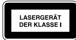
*Niemals mit einem Vergrößerungsgerät einen Übertragungs-Laser betrachten, während dieser eingeschaltet ist. Niemals direkt auf den Faser Anschluß und auf die Faserkabelenden schauen, während diese eingeschaltet sind.*
