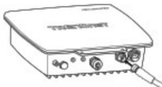
2. Поверните другой конец кабельного разъема к внешней антенне. Затяните оба разъема пальцами. После этого, при подключении питания наружной точки доступа, радиосигнал от такой точки автоматически поступит на внешнюю антенну (в обход встроенной антенны).
