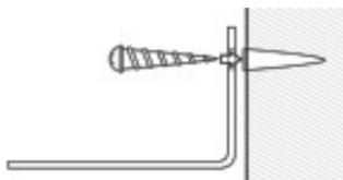
1. Выберите нужное место для кронштейна, воспользуйтесь кронштейном в качестве шаблона для разметки отверстий и просверлите два отверстия в отмеченных местах. Вставьте дюбеля в просверленные отверстия и прикрепите кронштейн к стене с помощью шурупов из комплекта.
