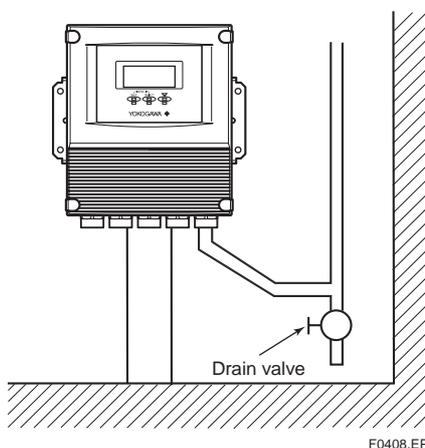
**Figure 4.3.5 Conduit Wiring**
