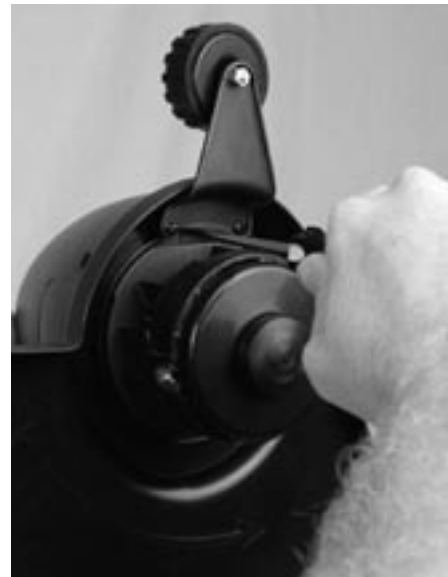
Figure 3-5 : Fixation du disque de coupe
