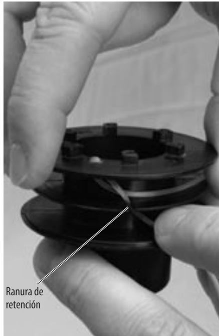
Figura 4-20: Colocación de la cuerda en el carrete
