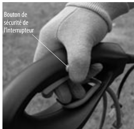
Figure 4-9 : Appuyez sur le bouton de sécurité de l'interrupteur
