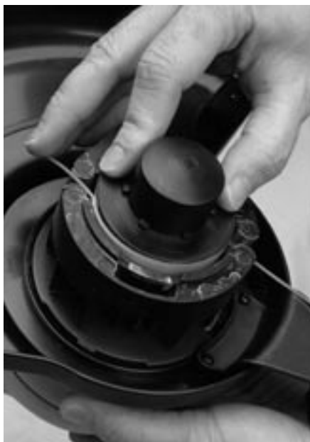
Figure 4-25 : Mise en place de la bobine dans le boîtier
