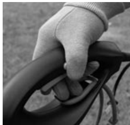
Figura 4-9: Presionando el botón de seguridad del interruptor de gatillo
