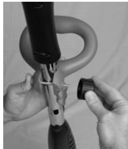
Figura 3-9: Atornillado de la perilla en el perno
