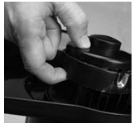
Figura 4-13: Desbloqueando la tapa del carrete
