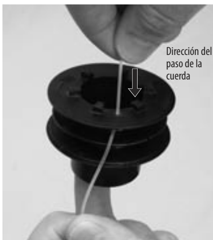
Figura 4-17: Insertando la cuerda en el orificio izquierdo
