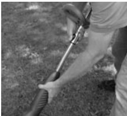
Figura 4-7: Regulación de la longitud del eje
