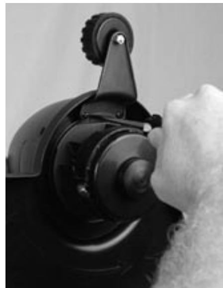
Figura 3-5: Sujeción de la rueda de la recortabordes
