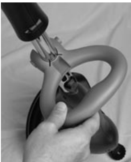
Figure 3-7 : Insertion de la poignée sur l'arbre
