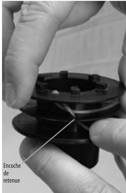
Figure 4-20 : Mise en place du fil dans la bobine
