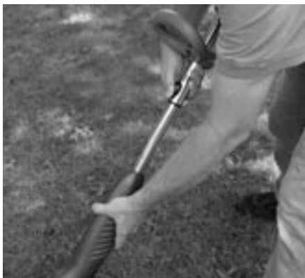
Figure 4-7 : Réglage de la longueur de l'arbre
