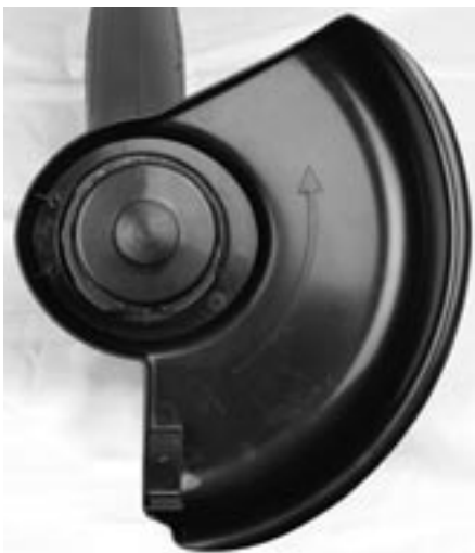
Figure 3-1 : Installation du protecteur de coupe sur la tête de l'outil
