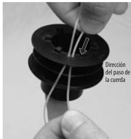
Figura 4-18: Inserción la cuerda en el orificio derecho
