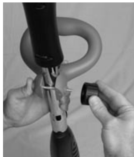
Figure 3-9 : Mise en place du bouton sur l'écrou
