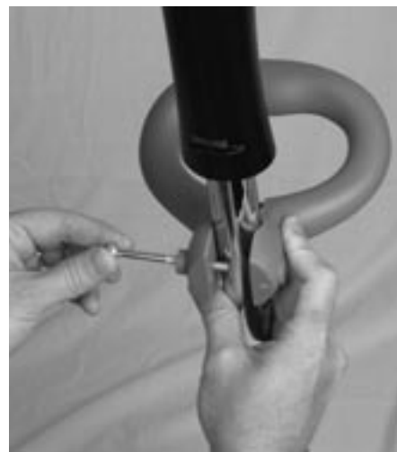
Figure 3-8 : Insertion de l'écrou dans la poignée
