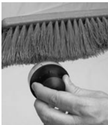
Figura 4-15: Limpieza del carrete
