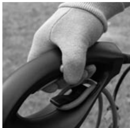
Figure 4-10. Appuyez sur l'interrupteur
