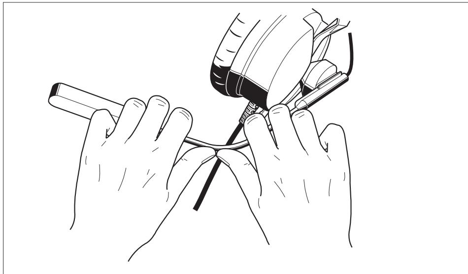
**Important :** Le bras du microphone est ajusté pour un utilisateur individuel. Si on l'ajuste plusieurs fois on risque de le briser !
