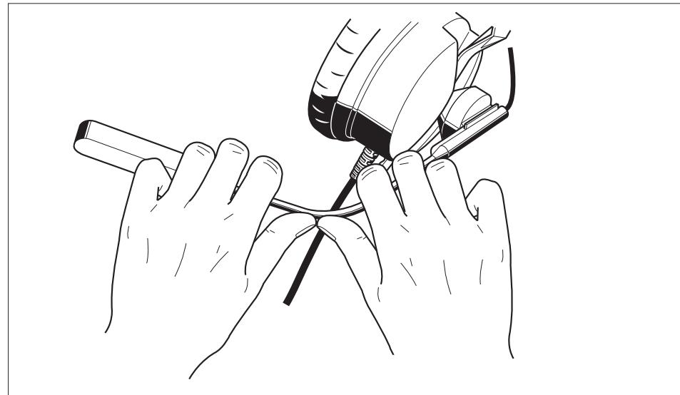
El brazo del micrófono puede doblarse para adaptarlo según el gusto individual. Sin embargo no es aconsejable cambiar este ajuste permanentemente; al doblar el brazo a menudo hacia un lado y otro podría romperse.
