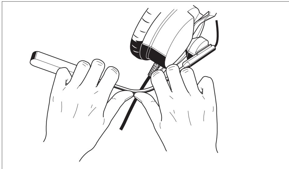
**Hinweis:** Der Mikrofonarm kann durch Biegen individuell angepaßt werden. Diese Einstellung sollte möglichst nicht ständig geändert werden, bei sehr häufigem Hin- und Herbiegen kann der Arm brechen!
