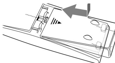
Si la plage de fonctionnement de la télécommande ou son efficacité diminue, remplacer les piles. Utiliser deux piles sèches de type R6P(SUM-3)/AA(15F).
