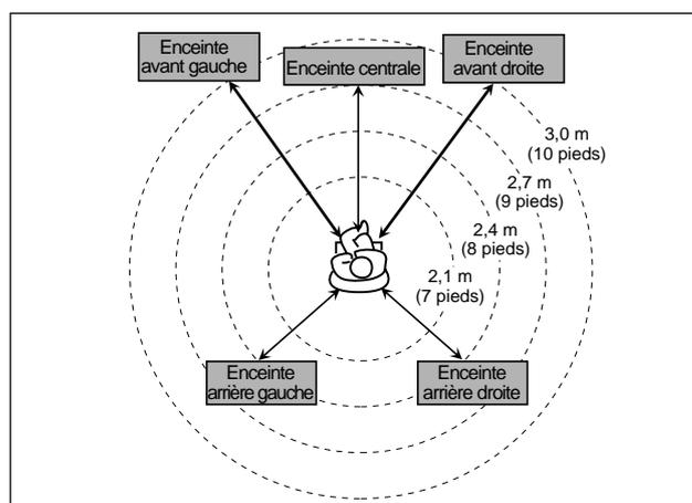
Exemple: Dans ce cas, régler "FRNT DIS" sur "3.0m" ou "10FT", régler "CNTR DIS" sur "2.7m" ou "9FT" et régler "REAR DIS" sur "2.4m" ou "8FT".
