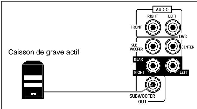
Connecter la prise d'entrée d'un caisson de grave actif à la prise SUBWOOFER OUT sur le panneau arrière en utilisant un câble à fiches cinch (non fourni).
