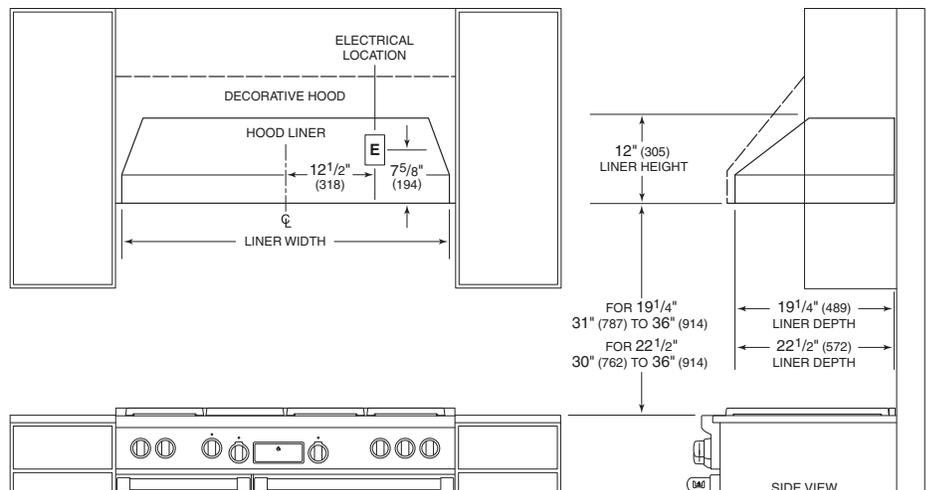
VERTICAL DISCHARGE ONLY FOR VENTILATION HOOD LINERS.
