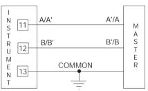
Fig. 10 - RS-485 WIRING
