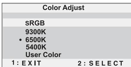
**sRGB** — sRGB 很快就会成为颜色管理的工业标准, 它支持很多最新的应用程序。启用此设置, LCD 可以更精确地显示原始色彩。启用 sRGB 设置后将关闭 Contrast (对比度) 和 Brightness (亮度) 调节。
