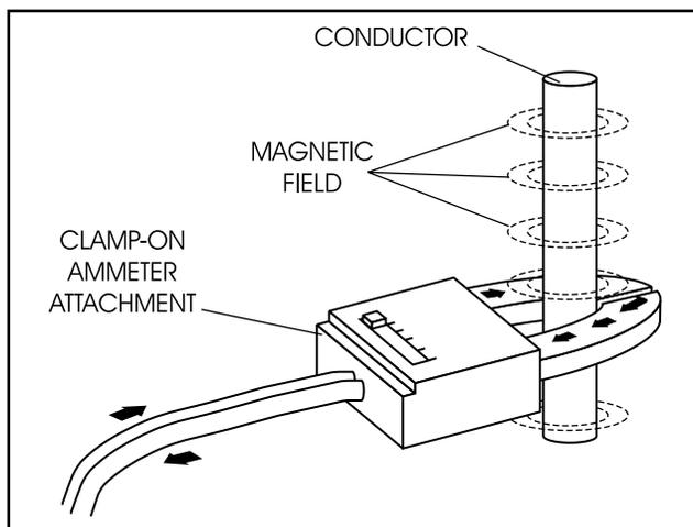
Figure 14. Clamp-On Ammeter
