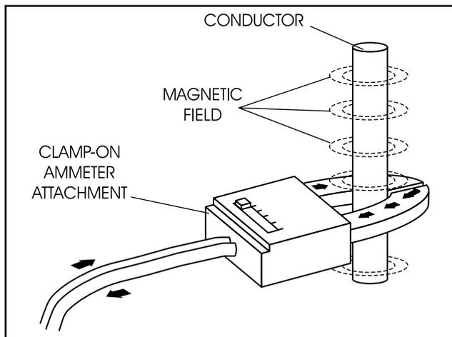
Figure 2. Clamp-On Ammeter
