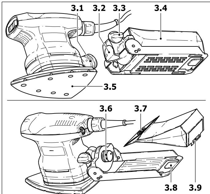
Las máquinas están equipadas como equipo de serie con un dispositivo autoaspirador. El polvo de lijado es aspirado por las aberturas de aspiración que se encuentran en el plato de lijado (3.5) y es recogido en el turbofiltro (3.4). Cuando el turbofiltro se ha llenado hasta el punto de que se nota una merma de la
