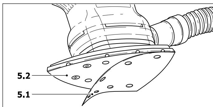
Les abrasifs autoagrippant (5.1) sont facilement placés sur le patin de ponçage (5.2) puis maintenus en toute sécurité par le revêtement autoagrippant du patin de ponçage Stickfix.
