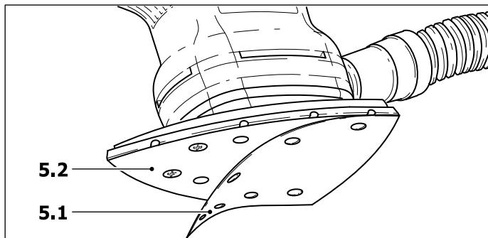
Los materiales abrasivos autoadheribles (5.1) se presionan simplemente sobre el plato de lijado (5.2) y son retenidos con seguridad por el recubrimiento adherente del plato de lijado Stickfix.
