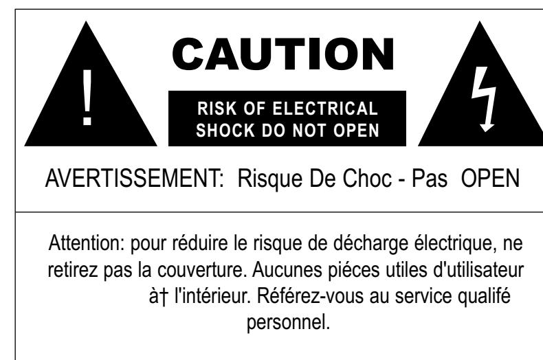
L'éclair clignotant avec un symbole de pointe de flèche, situé à l'intérieur d'un triangle équilatéral, a pour objet d'avertir l'usager de la présence de 'tension électrique dangereuse' non isolée à l'intérieur de l'enceinte acoustique du produit qui pourrait être d'ampleur insuffisante pour constituer un risque de choc électrique pour les gens.
