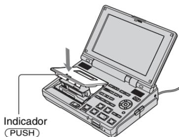
El compartimiento del videocasete se desliza automáticamente a su posición de cierre.
