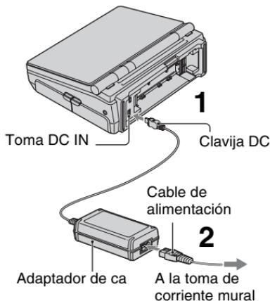
**1** Conecte el adaptador de ca a la toma DC IN de la videograbadora. Asegúrese de que la indicación ▲ de la clavija DC coincide con la indicación ▲ de la videograbadora.
