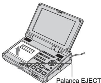
El compartimiento del videocasete se eleva y se abre de forma automática.
