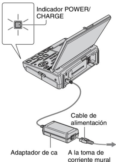
El indicador POWER/CHARGE se apaga cuando la batería está completamente cargada. Después de cargar la batería, desconecte el adaptador de ca de la toma DC IN de la videograbadora.
