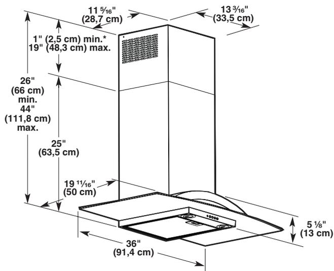
**\*IMPORTANT :** Pour une installation sans décharge à l'extérieur (recyclage), la dimension minimale est de 6" (15,2 cm).
