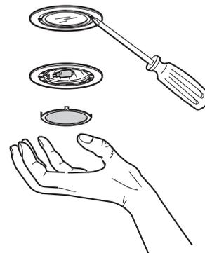
3. Enlever la lampe. Installer une lampe à halogène neuve de 12 V/20 W maximum, à culot de type G-4.
