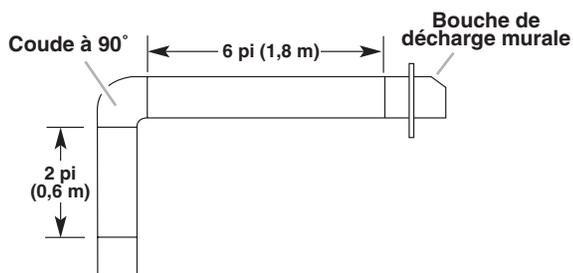
La longueur maximale du circuit ne doit pas dépasser 50 pi (15,2 mètres), ce qui est le cas pour l'exemple suivant.
