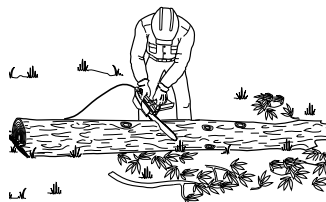
Figura 14 - Trozado del tronco completamente apoyado en el suelo
