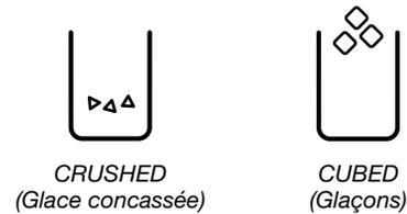
Pour de la glace concassée, les glaçons sont concassés avant d'être distribués. Cette action peut causer un court délai lors de la distribution de glace concassée. Le bruit du broyeur de glaçons est normal et la dimension des morceaux de glace peut varier. Lorsqu'on passe du mode glace concassée au mode glaçons, quelques onces de glace concassée sont distribuées avec les premiers glaçons.
