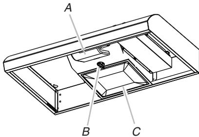
A. Logement et protège-ampoule de l'ampoule à incandescence
