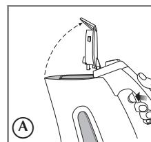
1. Pour faire bouillir de l'eau, appuyer sur le déclencheur de couvercle à l'intérieur de la poignée afin d'ouvrir le couvercle (A). Le couvercle se verrouille en position ouverte.
