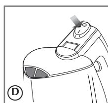
5. Pour mettre en marche la bouilloire, placer l'interrupteur I/O (marche/arrêt) situé sur le haut de la poignée sur la position I (marche) (D). Le voyant lumineux s'allume (E).
