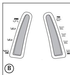
2. Llene el hervidor con agua hasta el nivel deseado. Este hervidor tiene marcas de nivel en dos lados de manera que usted puede medir ya sea en onzas/tazas o litros. Asegúrese de no exceder la línea MAX de la marca para nivel de agua (B).
