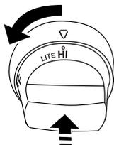
3. On doit constater l'allumage de l'allumeur. Lorsque le brûleur est allumé, lâcher le bouton; tourner le bouton de commande au réglage désiré.
