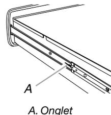
3. Abaisser l'onglet du côté droit et soulever l'onglet du côté gauche en même temps, puis retirer le tiroir d'un pouce supplémentaire pour libérer le loquet.
