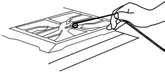
5. Pour le brûleur le plus proche de l'allumette, enfoncer et faire tourner le bouton du robinet jusqu'à la position LITE/Hi. Le brûleur s'allume immédiatement. Lorsque le brûleur est allumé, tourner le bouton jusqu'au réglage désiré.
