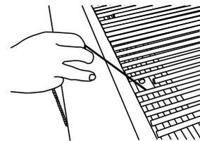
5. Pour le brûleur le plus proche de l'allumette, enfoncer et faire tourner le bouton du robinet jusqu'à la position LITE/HI. Le brûleur s'allume immédiatement. Lorsque le brûleur est allumé, tourner le bouton jusqu'au réglage désiré.
