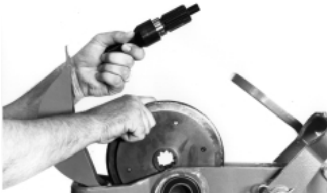
Figure 12 – Retrait du disque de tronçonneuse
