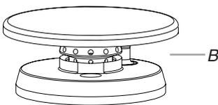
5. Allumer le brûleur. Si le brûleur ne s'allume pas, vérifier l'alignement du chapeau. Si le brûleur ne s'allume toujours pas, ne pas réparer vous-même le brûleur scellé. Contacter un technicien de réparation qualifié.
