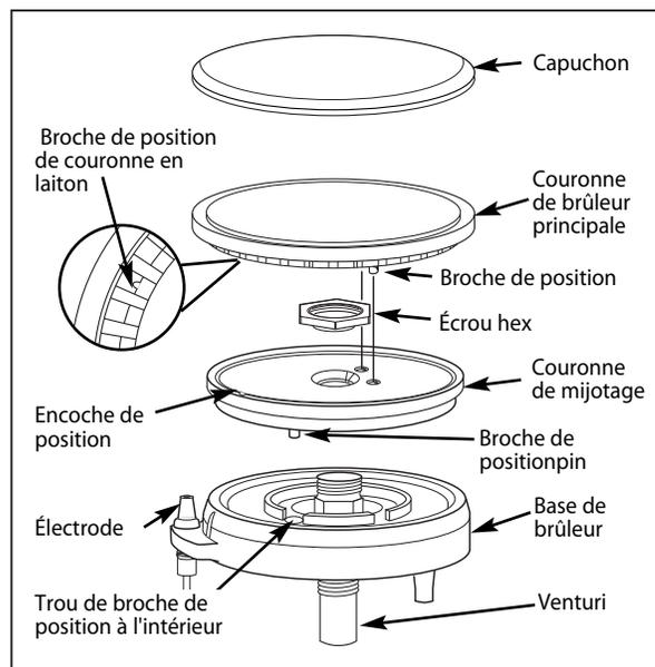
Après le nettoyage, il est important de vous assurer que la broche de position au bas de la couronne de mijotage est correctement alignée avec le trou correspondant de la base et que la broche de position au bas de la couronne en laiton est correctement alignée avec l'encoche de position en haut de la couronne de mijotage. Un mauvais alignement produira une flamme potentiellement dangereuse et entraînera un mauvais fonctionnement du brûleur. Voir l'illustration ci-dessus.
