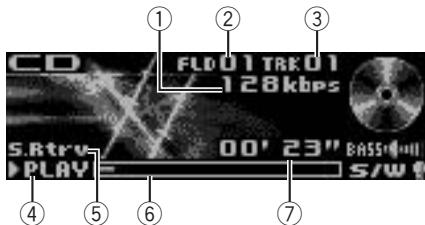
① Indicateur de fréquence d'échantillonnage/ débit binaire
