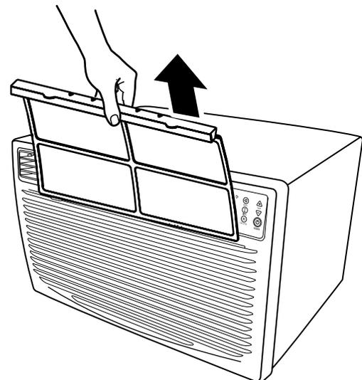
3. Nettoyer le climatiseur à l'aspirateur. Si le filtre est très sale, le laver avec de l'eau tiède et un détergent doux. Ne pas laver le filtre à air au lave-vaisselle ni utiliser un produit nettoyant chimique.
