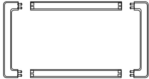
2. Installer le ruban de mousse isolante de 1/8" autour de la rive interne du cadre de garniture. Commencer dans l'angle inférieur gauche, et placer le ruban de mousse isolante sur tout le périmètre du cadre de garniture. Veiller à placer le ruban de mousse en affleurement avec le bord inférieur du cadre de garniture.
