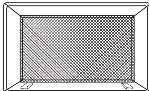
3. Si nécessaire, percer des trous de  $\frac{1}{8}$ " dans la gaine murale. Puis, placer les vis avec rondelle pour fixer la grille sur la gaine murale.
