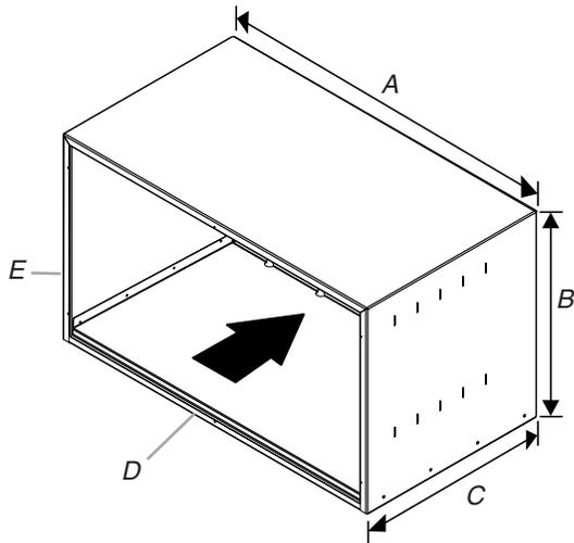
A. Largeur (L)      D. Tige d'isolant pour composants horizontaux
