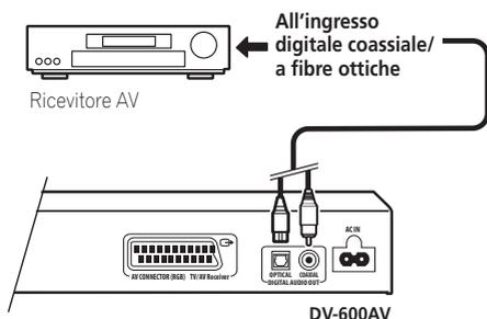
*Solo DV-600AV:* Per fare collegamenti ottici, usare un cavo (opzionale) a fibre ottiche per collegare **OPTICAL DIGITAL AUDIO OUT** ad un ingresso digitale del vostro ricevitore AV. Per un collegamento via cavo coassiale, utilizzare un cavo coassiale (simile al cavo video fornito) per collegare l'uscita **COAXIAL DIGITAL AUDIO OUT** a un ingresso coassiale del ricevitore AV.
