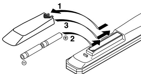
**1** Appuyez sur la partie ▼ et faites glisser le couvercle du logement des piles.
