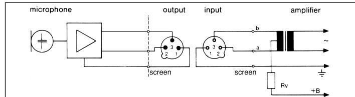
Circuito com transformador de entrada **sem** derivação central (isolado da terra):
