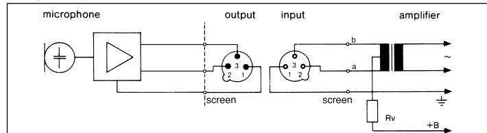
Collegamento con trasformatore d'ingresso **senza** presa mediana (senza terra).
