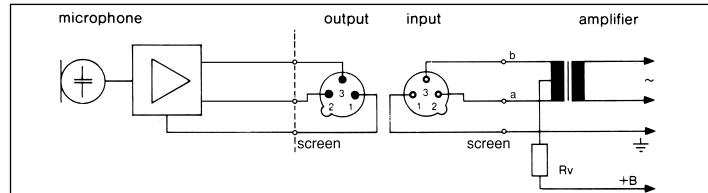
Conexión con transformador de entrada **sin** derivación central (aislado de tierra):
