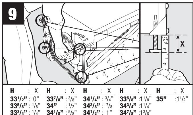
X = Adjusted Foot Height/Altura Ajustada de la Pata/
