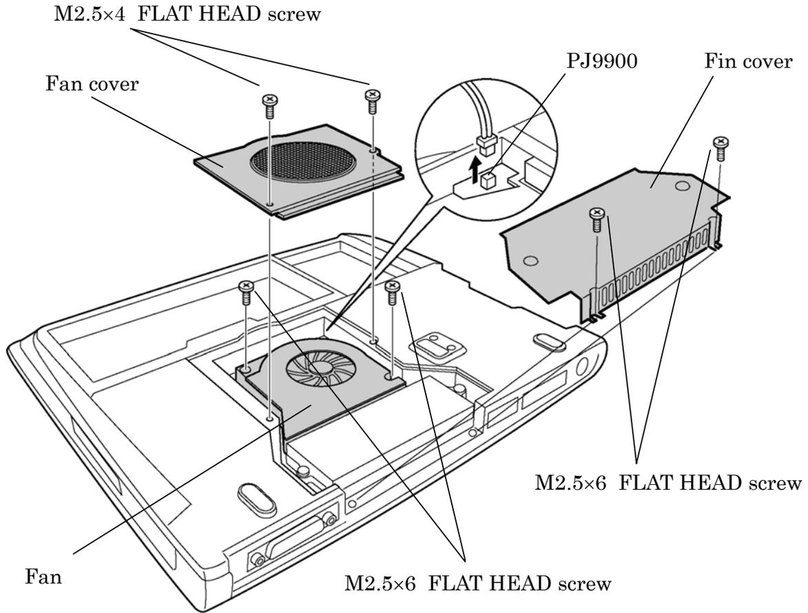
Figure 4-10 Removing the Cooling fan module
